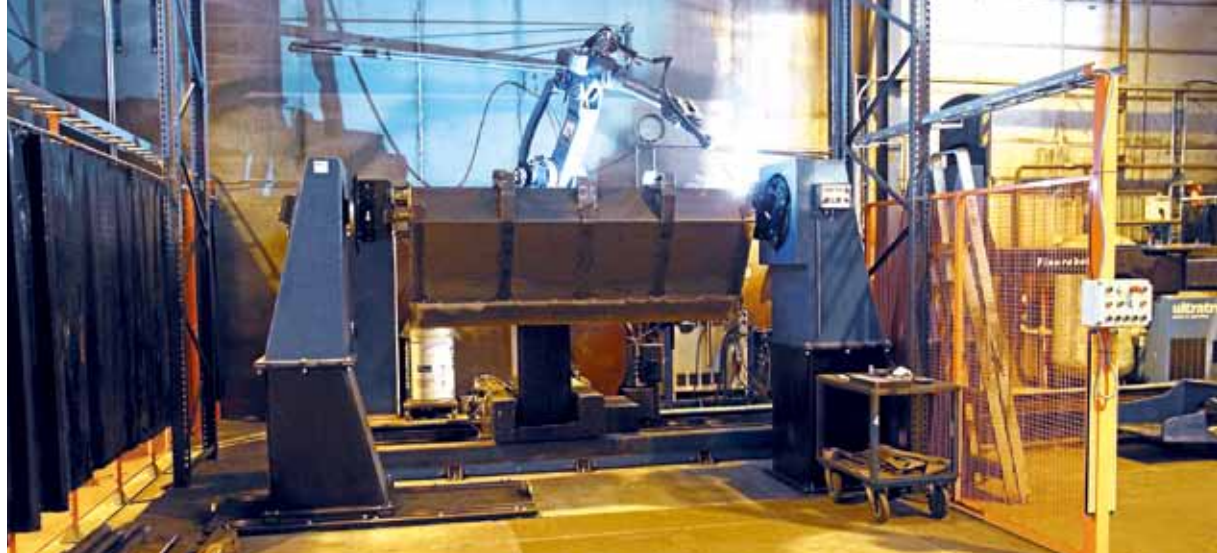
↑ Robottihitsauslaitteella kurottajan kauha saadaan hitsattua tehokkaasti ja laadukkaasti.
